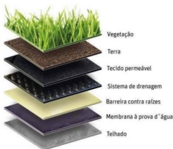
Figura 8: Estrutura do Telhado verde
