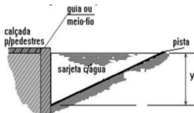
Figura 2: Sarjeta em concreto
