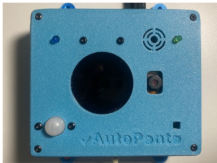
Figura 19 – Dispositivo AutoPonto montado na caixa de proteção
