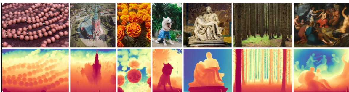
Figura 5 - Estimativa de profundidade monocular com o modelo Marigold. A fileira superior exibe as imagens originais RGB; a inferior, os respectivos mapas de profundidade, onde tons quentes indicam menor distância espacial. Fonte: Bing et al. (2024) - Adaptado pelo autor
