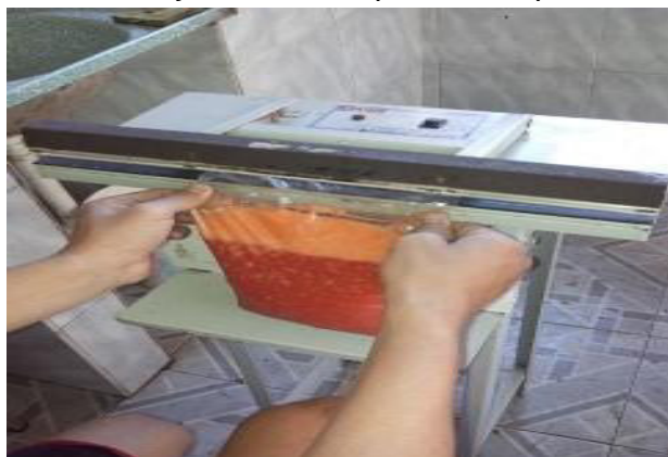
Figura 8: Produto final já ensacado passando pela máquina de selagem.
