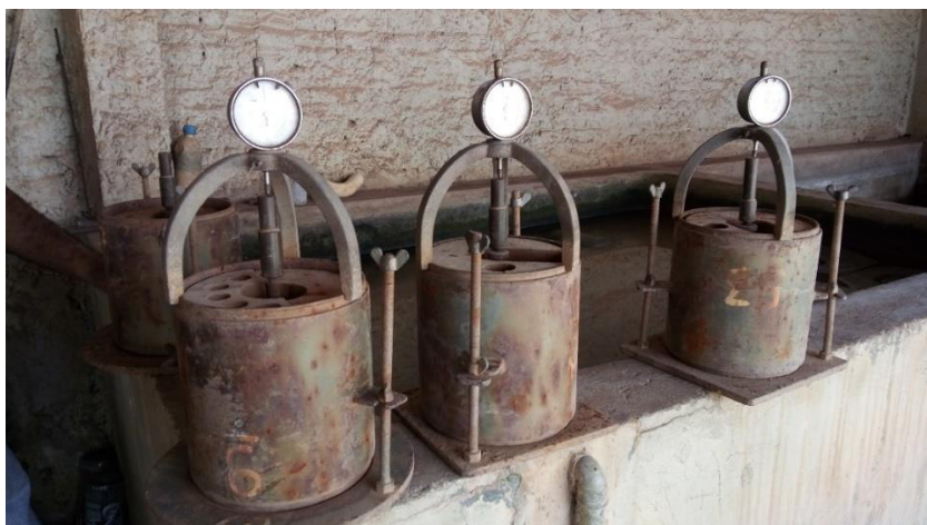
Figura 34 – Alguns moldes com sobrecarga e haste de medição de expansão.
