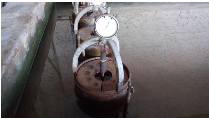
Figura 35 – Moldes com sobrecarga e haste de medição de expansão dentro do tanque.
