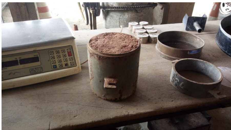
Figura 30 – Molde + Solo úmido após o arrasamento.
