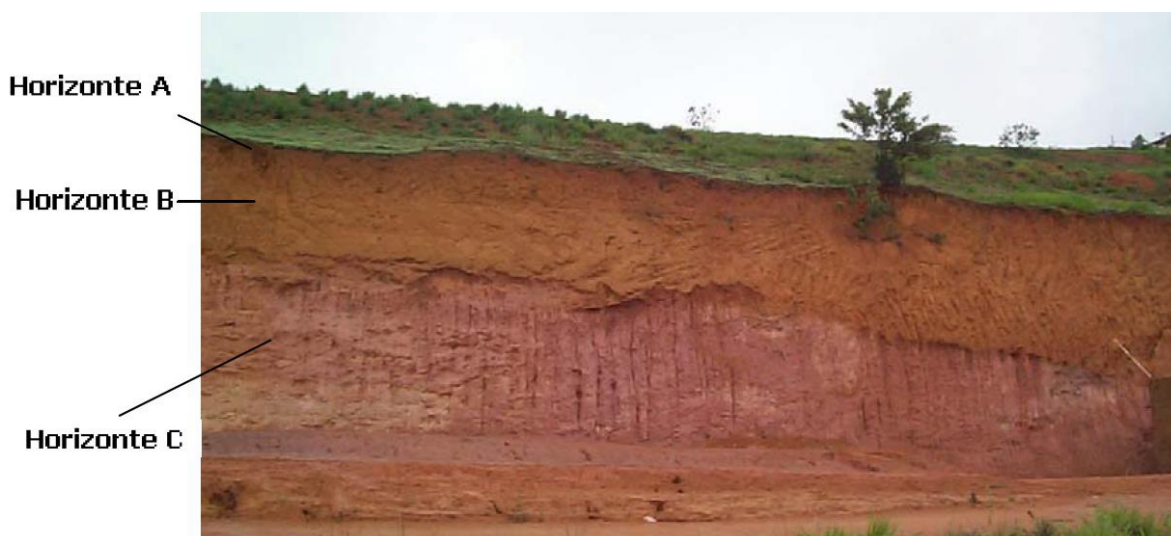
Figura 2 – Perfil de solo com nítida distinção entre os horizontes A, B (laterítico) e C (saprolítico), sendo os dois primeiros pouco espessos.
