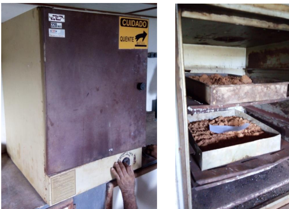
Figura 23 – Amostras 01 e 02 secando na estufa à 105 °C.
