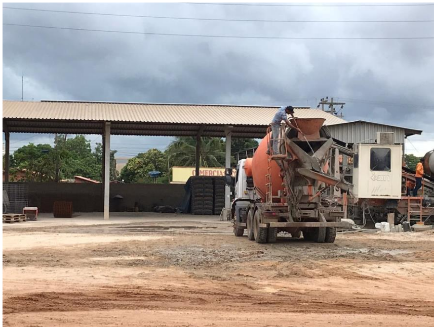
Figura 10 - Lavagem do caminhão betoneira
