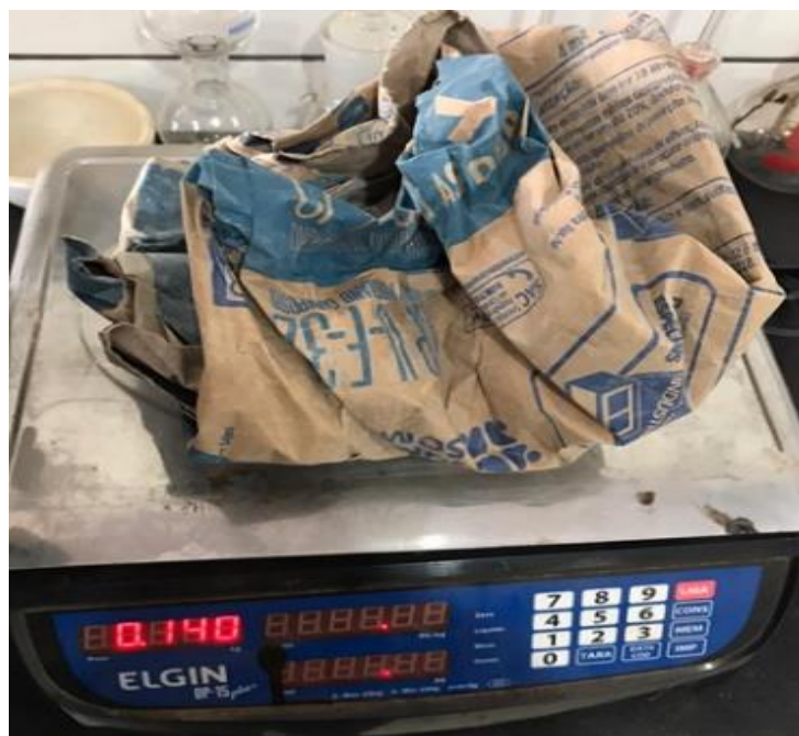
Figura 8 - Pesagem dos sacos de cimento
