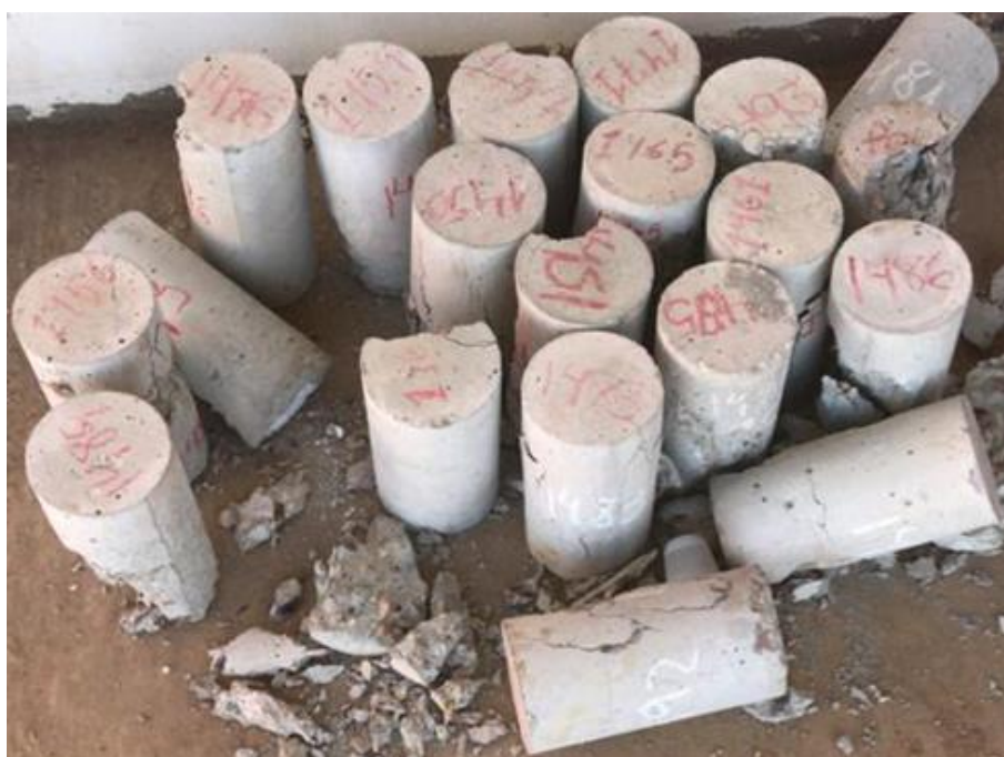
Figura 11 - Corpos de provas rompidos
