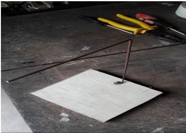
Imagem 2. Haste de ferro parafusada na base de madeira. Autoria própria.
