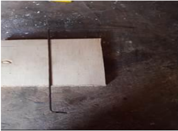
Imagem 1. Haste de metal e bloco de madeira para construção do pêndulo eletrostático. Autoria própria.
