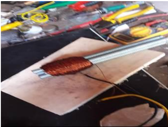
Imagem 15. As hastes de ferro enrolados com cobre. Autoria própria
