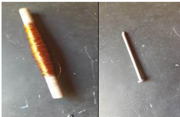
Imagem 5. Cobre e prego para construção do eletroímã. Autoria própria
