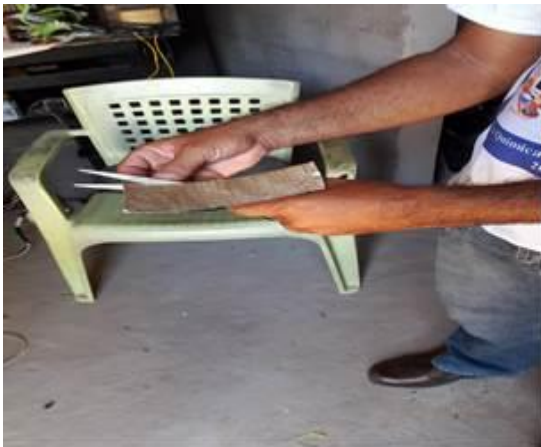
Imagem 9. Corte de uma chapa de alumínio para construí suporte para bobina. Autoria própria.
