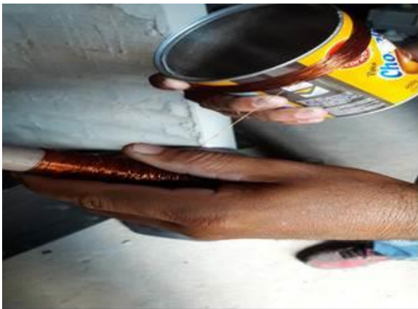
Imagem 12. Fios de cobre sendo enrolados em uma lata. Autoria própria.
