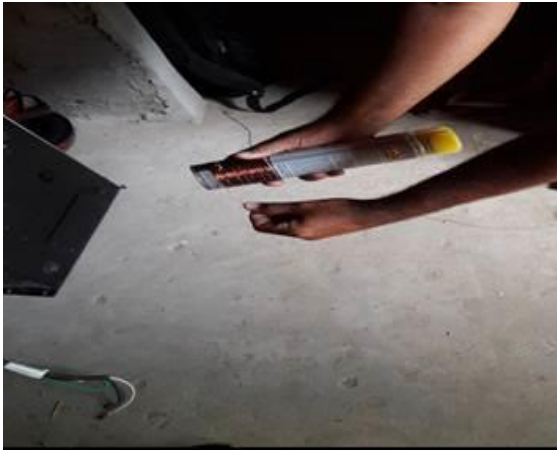
Imagem 8. Enrolamento de fio de cobre para formar uma bobina. Autoria própria.
