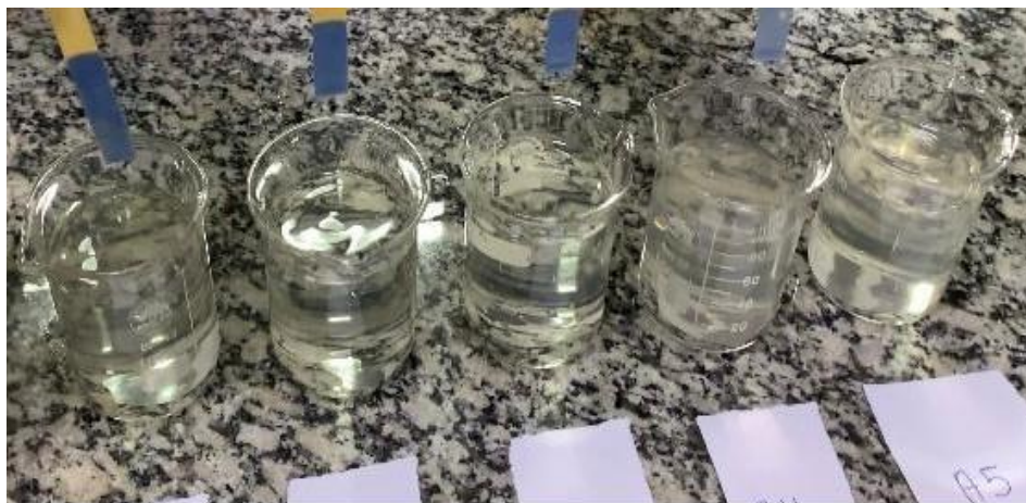
Figura 9: Determinação do valor do pH das amostras com papel tornassol
