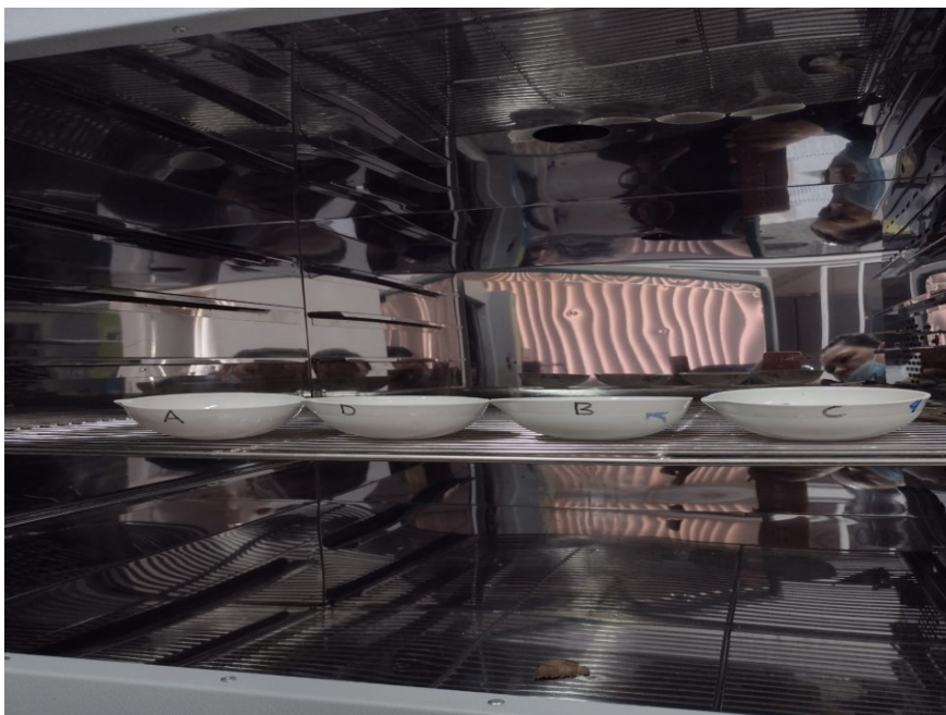
Figura 3. Estufa e cápsulas de porcelana para a determinação da umidade
