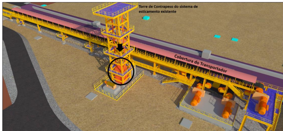
Figura 73 - Alívio do contrapeso da torre de esticamento.
