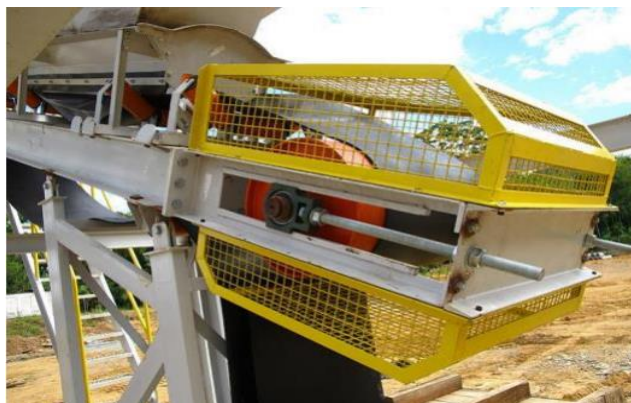
Figura 33 - Sistema de esticamento - Esticador de correia por parafuso.
