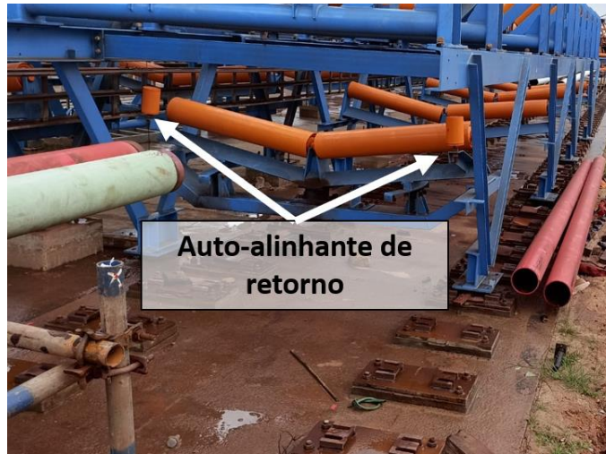
Figura 24 - Rolete auto-alinhante de retorno.
