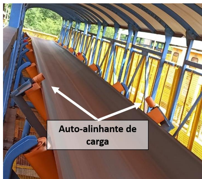
Figura 23 - Rolete auto-alinhante de carga.
