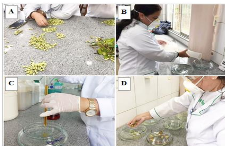
Figura 2: A- Processo de triagem dos propágulos de L.racemosa ; B- Adição da água estuarina nas cubetas; C- Adição do ODM nas cubetas; D- Adição dos propágulos nas cubetas submetidos à emulsificação com diferentes percentuais de ODM.
