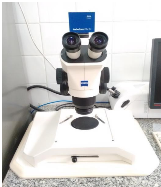
Figura 7 - Estereomicroscópio da marca Zeiss Stemi 2000-C, utilizado durante as triagens e registro dos organismos.
