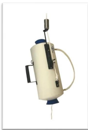
Figura 2: Garrafa hidrológica do tipo Van Dorn de 5L utilizada para as coletas de água em superfície no Complexo Estuarino da Raposa-MA.
