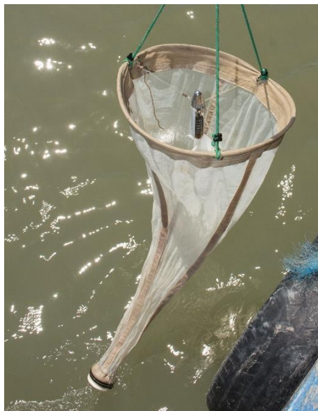
Figura 4: Rede cônico-cilíndrica utilizada nos arrastos durante as coletas do ictioplâncton no Complexo Estuarino da Raposa-MA.
