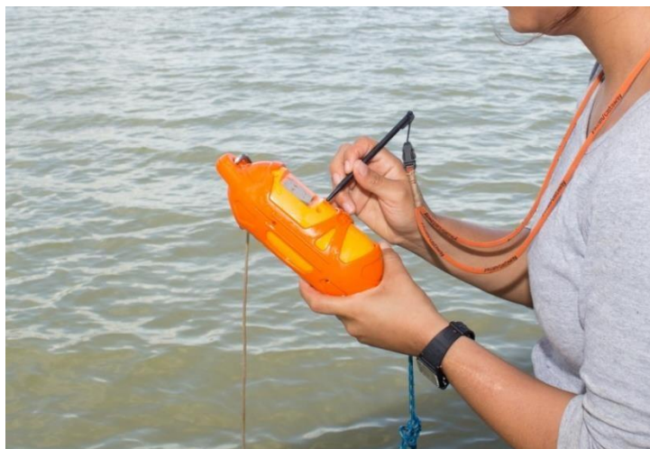
Figura 3: Equipamento CTD do modelo YSI CASTWAY utilizado para coleta dos dados de profundidade, temperatura e salinidade no Complexo Estuarino da Raposa-MA.
