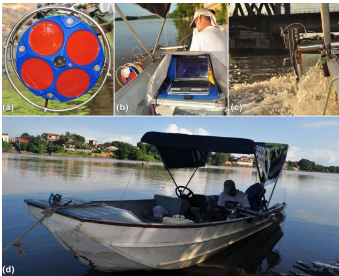
Figura 3- Esquema da instalação perfilador de correntes (a) ADCP conectado ao (b) Notebook e suas configurações em (c) operação e (d) repouso na embarcação utilizada durante as campanhas ITA-02 e MOS-02.
