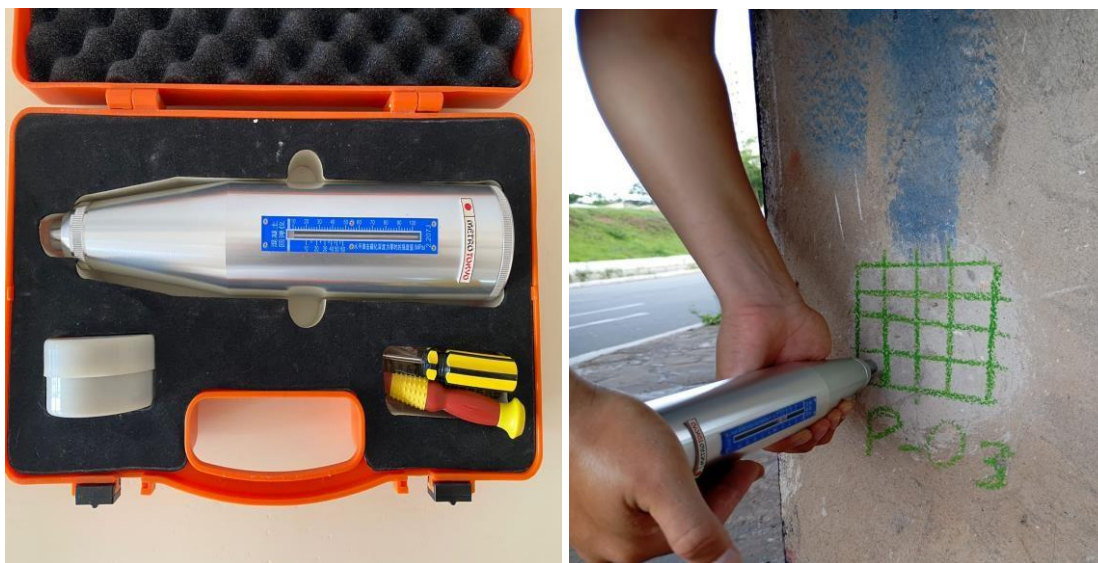
Figura 8a e 8b: Esclerômetro usado no teste e processo de ensaio em execução, respectivamente.
