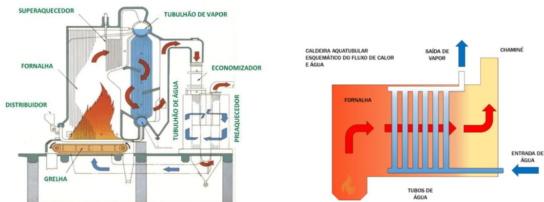
Figura 6. Arquitetura e esquemático do fluxo de calor e água de uma caldeira aquatubular
